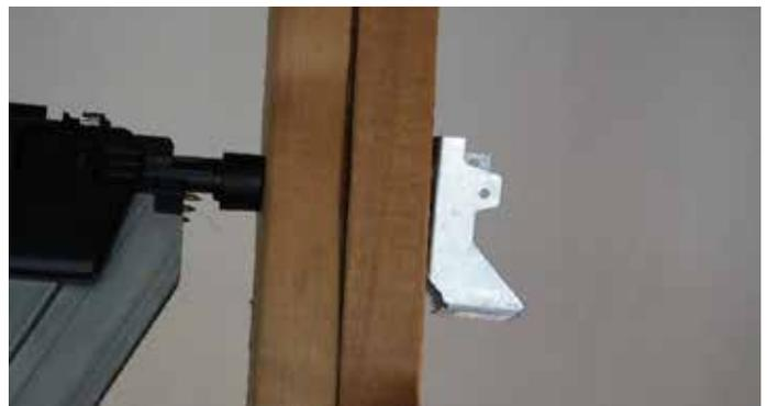
Las superficies delgadas pueden ocasionar que la fijación se dispare completamente a través de la superficie de trabajo hacia
